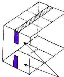
Die Überlappung bei der Prüfung betrug 50 mm.
